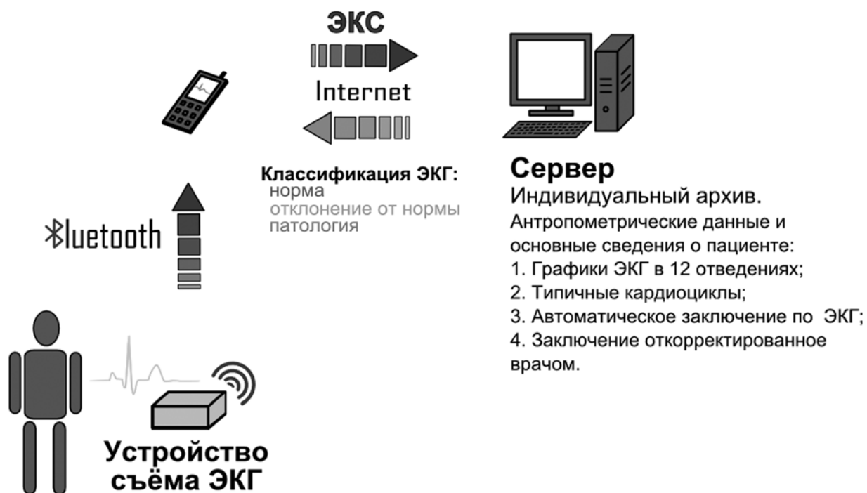
Рис. 1. Схема ЭКГ-телеметрии. 1 – измеряемый объект (человек). 2 – устройство съема информации. 3 – мобильный телефон. 4 – сервер для хранения и обработки электрокардиографического сигнала.
