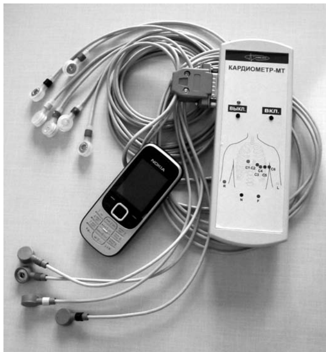
Рис. 3. Устройство съема информации, комплект электродов и проводов для съема ЭКГ в 12 общепринятых отведениях и мобильный телефон, дополненный специальной программой, позволяющей осуществить синхронную 24 секундную запись кардиосигнала и его передачу через Bluetooth на сервер с последующим отображением шкал, характеризующих ритм сердца и форму предсердно-желудочкового комплекса
